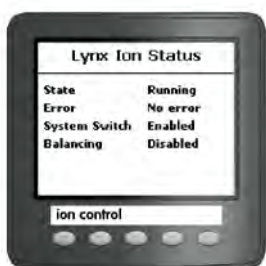
Ion control : Écran d'état du Lynx Ion
