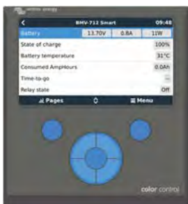
Color Control Caché derrière les boutons et l'écran couleur, le puissant ordinateur Linux rassemble les données provenant de tout équipement Victron et il les affiche à l'écran. En plus de communiquer avec l'équipement Victron, le Color Control communique à travers un bus CAN (NMEA2000), Ethernet et USB. Les données peuvent être stockées et analysées sur le portail VRM.
